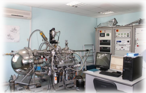
Модуль электронно-ионной спектроскопии Нанофаб 25
