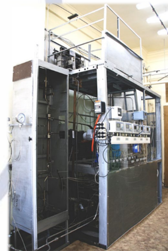
Высокотемпературная установка для изучения процессов коррозии и образования отложений
