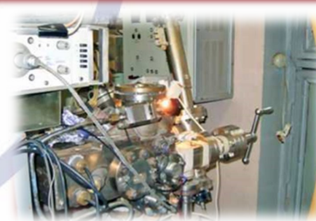
Стенд для спектров электронов, отраженных от поверхности материалов
