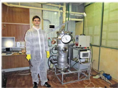
Экспериментальный стенд «Режимы охлаждения высокотемпературных поверхностей»
