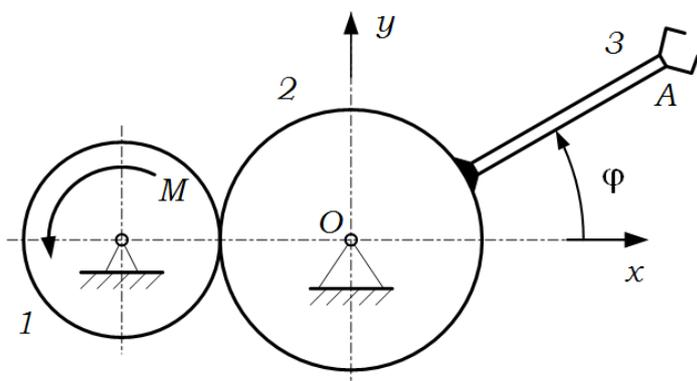
Манипулятор, схема которого приведена на рисунке, работает в вертикальной плоскости. Стрела манипулятора 3 жёстко соединена с зубчатым колесом 2, на которое передаётся вращение с шестерни 1. Перечисленные тела считать абсолютно твёрдыми и однородными. Заданы массы  $m_j$  и радиусы колёс  $r_1$  и  $r_2$ , а также длина стрелы  $l = OA$  (индексы отвечают номеру тела на схеме). Момент,
